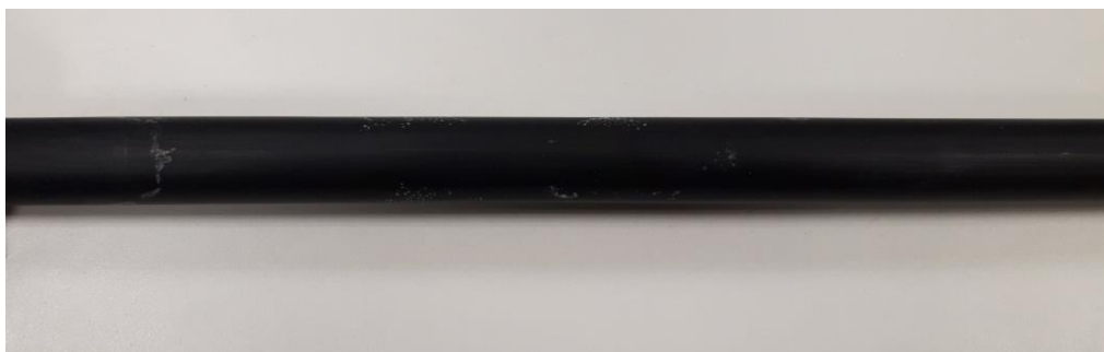
Muestra 4 tras el ensayo de índice de polución 5
