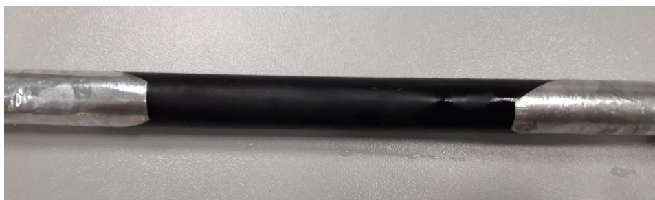
Muestra 3 tras el ensayo de índice de polución 7.7
