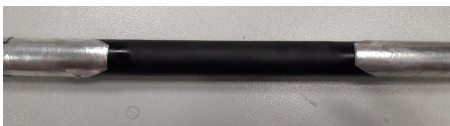
Muestra 2 tras el ensayo de índice de polución 7.7
