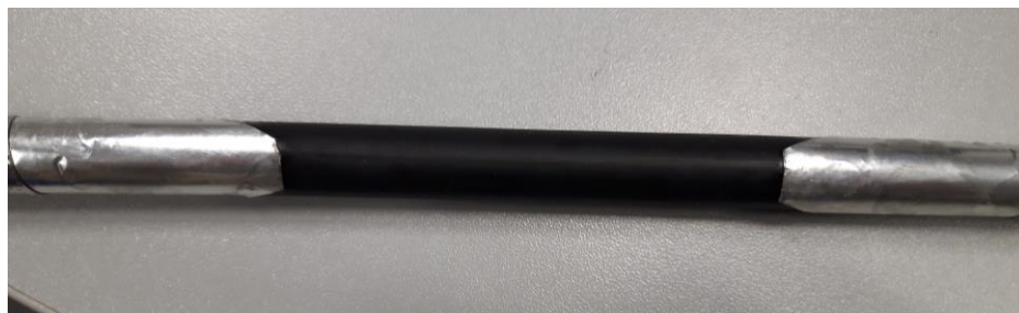
Muestra 1 tras el ensayo de índice de polución 7.7
