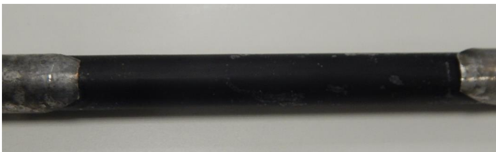
Muestra 9 tras el ensayo de índice de polución 6
