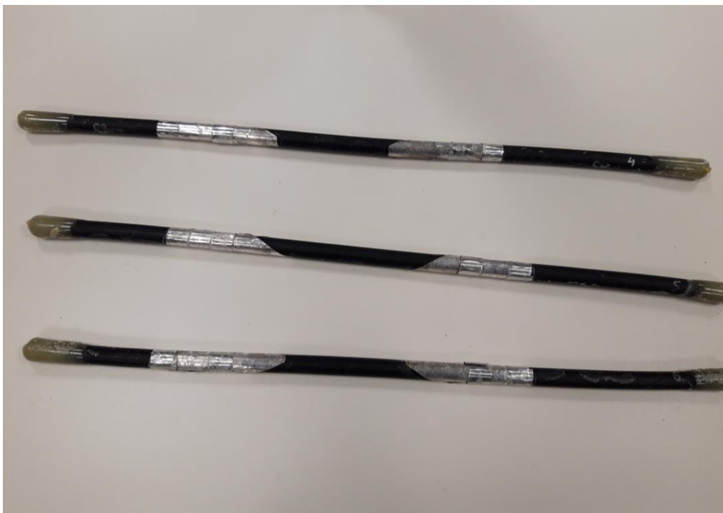
Muestras 4 5 y 6 tras el ensayo de índice de polución 5
