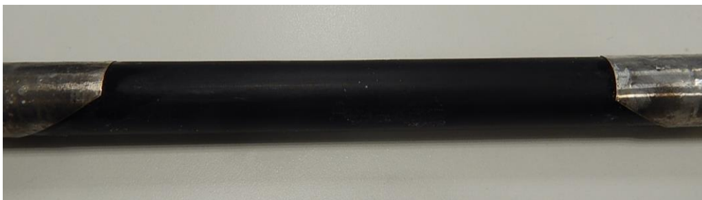
Muestra 8 tras el ensayo de índice de polución 6
