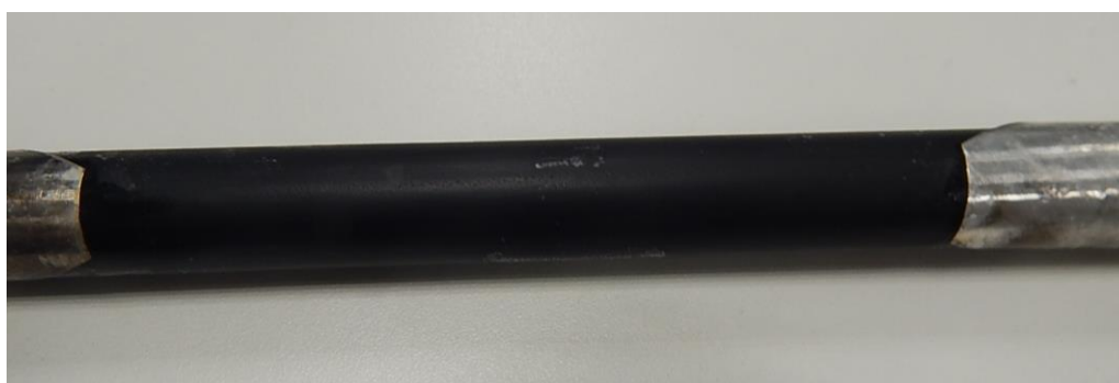
Muestra 7 tras el ensayo de índice de polución 6
