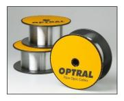
Fibras ópticas multimodo de 62,5/125 micras de índice gradual. Estas fibras están diseñadas para ser utilizadas a 850 nm y 1300 nm. Adecuadas para su uso en aplicaciones de cableado como las Redes de Área Local (LAN) con video, datos y voz, utilizando LED, VCSEL o Laser Fabry Perot.
